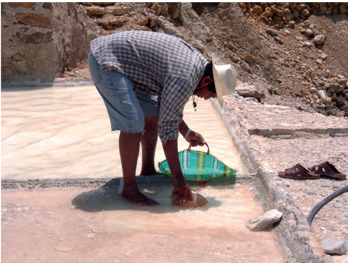
Eliminando el polvo y la basura del agua entre dos estanques con el uso de bolsa de plástico. Salinas Las Grandes, Zapotitlán Salinas, Puebla, abril de 2005. © Fotografía: Blas Román Castellón Huerta.
